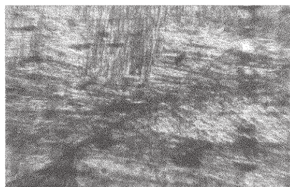
Microstructura probei sudate de Ti gr. 2 - rădăcina sudurii (x 200)
